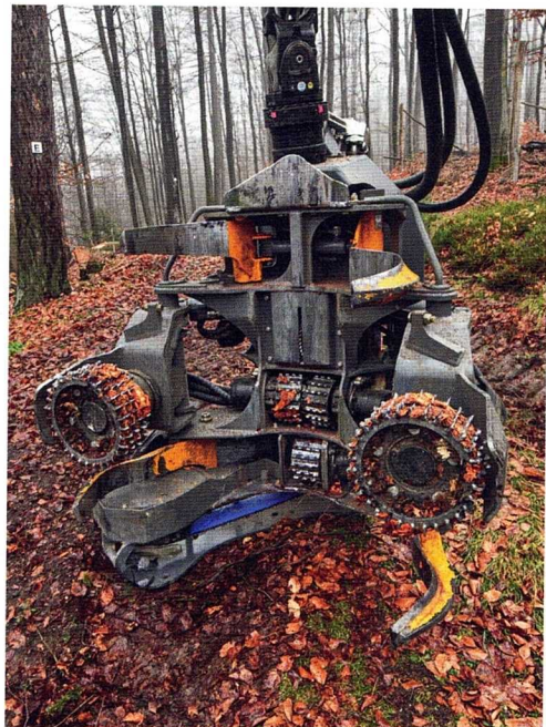
Das kurz gebaute Rottne EGS 607 eignet sich gut für die Laubholzernte
